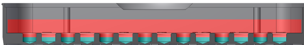
Obrázek 12.3 Kultivační jamky jsou přikryté vrstvou minerálního oleje a zakryté víkem
